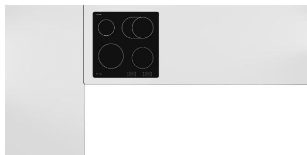
Abbildung 16: FALSCH – Positionierung von Spüle / Kochfeld
