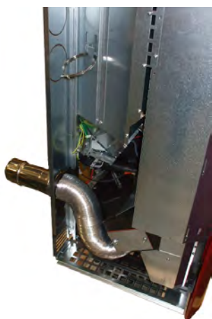
Fig. 47 - Positionierung der Rohre für hinteren Kanal
