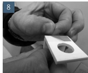
Schutzfolie vom Klebestreifen entfernen
