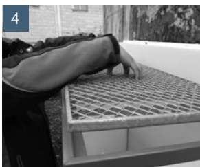
Rost mittig anheben und entnehmen
