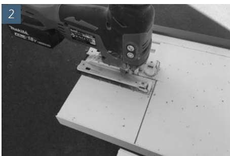
Ausklinkung mit Stichsäge vornehmen
