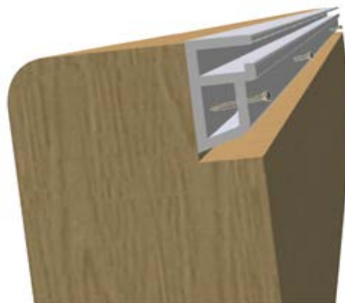
Abbildung 25 – Installation des Klemmprofils
