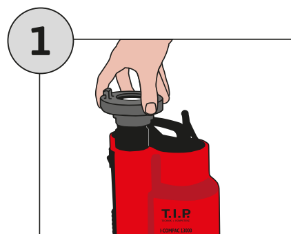
Beiliegende Storzkupplung an die Pumpe montieren.
