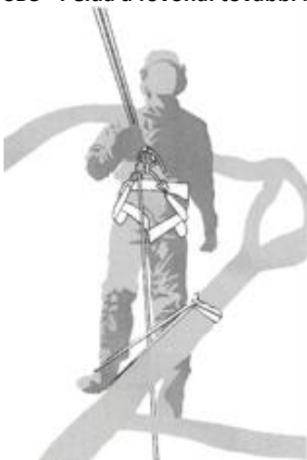
SB3 - Példa a fővonal további horgonyon keresztüli átirányítására
