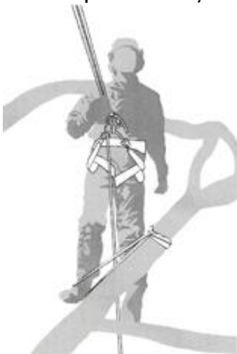
SB3- Exemplul de redirecționarea liniei principale prin ancoră suplimentară
