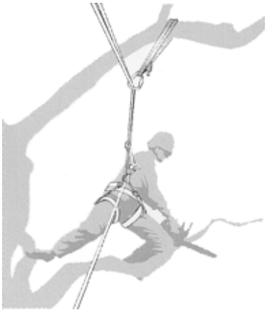
SB3 - Beispiel der Umlenkung der Hauptlinie über den Zusatzanker
