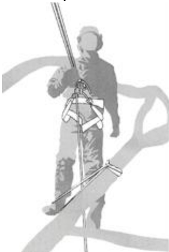
SB4 - Exemple d'étrier de pied temporaire en bande élastique
