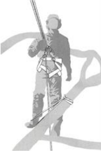
SB3 - Beispiel der Umlenkung der Hauptlinie über den Zusatzanker
