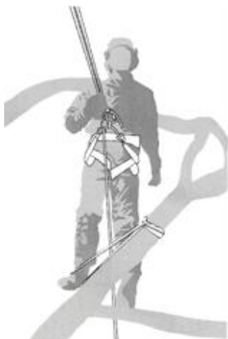
SB4 - Shembull i lidhjes së përkohshme të këmbës e krijuar nga litarët tepër të gjatë
