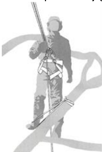
SB4 - Primer privremene uzengije za stopalo koja je napravljena od elastične trake
