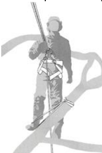
SB4 - Primer stojišča s pomožno oporo za noge iz zanke
