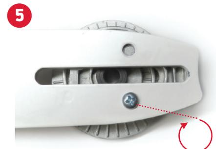
**SCHRITT 5:** Spanner am Führungsschwert befestigen. Die Schraube von der Rückseite des Kettenspannrads einführen und festziehen, um das Kettenspannrad am Führungsschwert zu befestigen.
