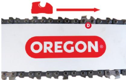
**ACHTUNG!** Stellen Sie sicher, dass die Sägezähne in die richtige Richtung weisen (D).
