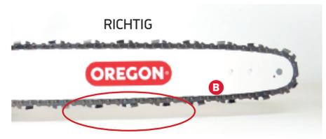
**SCHRITT 11:** Ziehen Sie etwas an der Kette. Die Spannung ist richtig, wenn die Kette zurückschnappt, nachdem sie 3 mm vom Führungsschwert weggezogen wurde.
