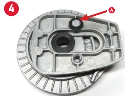
**ACHTUNG!** Der schwarze O-Ring (A) ist für den Betrieb der Säge wichtig. Der schwarze O-Ring muss sich am Stift des Spanners befinden, bevor der Spanner an das Schwert geschraubt wird.
