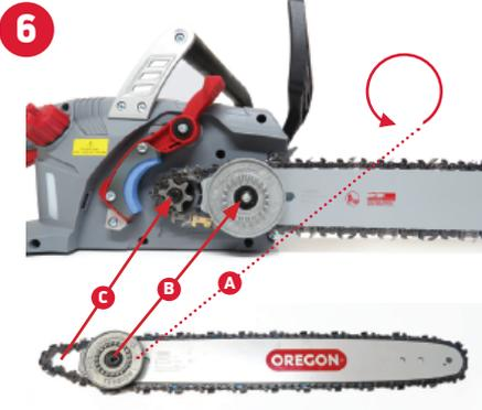
**SCHRITT 6:** Lösen Sie zunächst den Spanner (A) vollständig und befestigen Sie das Schwert und die Kette an der Kettensäge. Vergewissern Sie sich, dass die Schienen mit der Spannvorrichtung korrekt auf den Kettenspannbolzen (B) aufgeschoben wurde und die Kette sich über dem Antriebsritzel (C) befindet.
