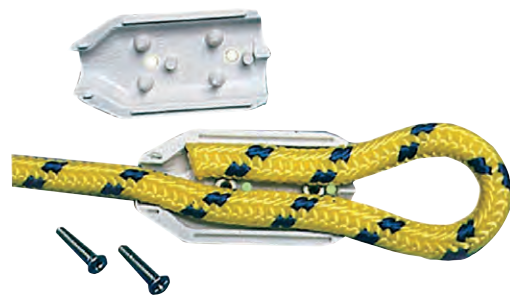
Mordaza para cabos. Fabricado en dos piezas de plástico blanco, tornillos de acero inoxidable y tuercas de latón empotradas para no dañar las superficies.
