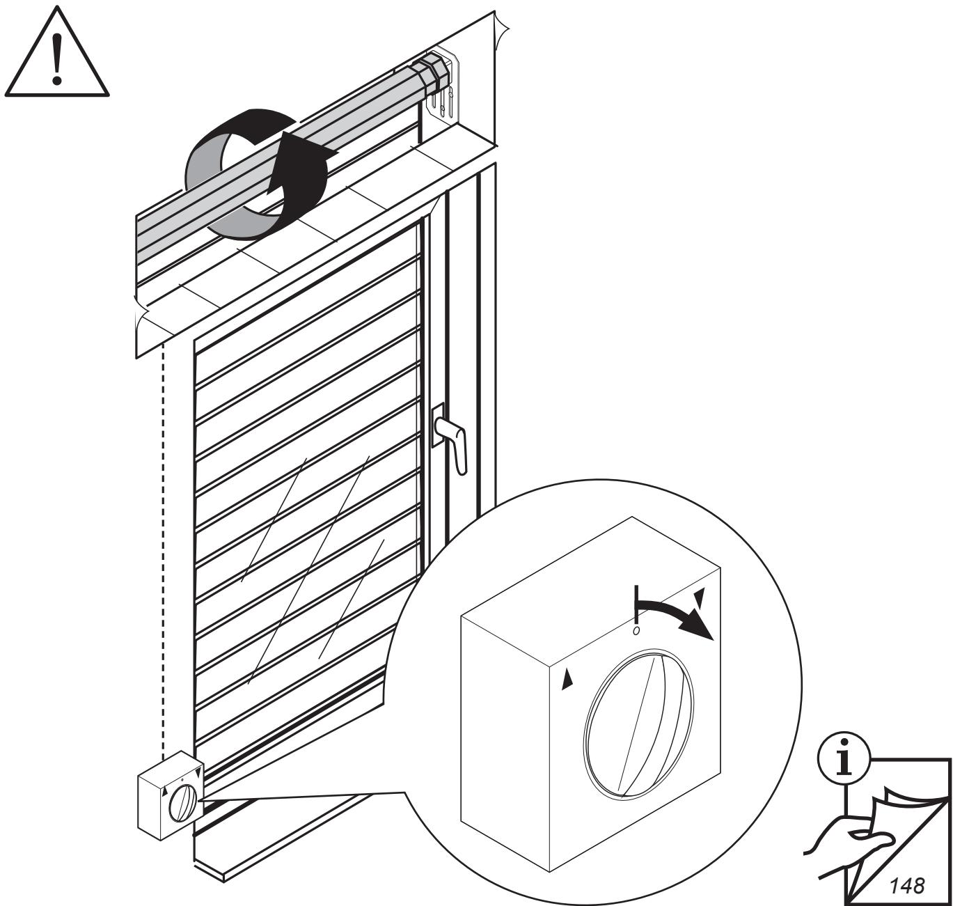
**DE** Nach Anschluss der Elektrik muss bei Befehl AB (▼) die Welle in die entsprechende Richtung drehen (s. Abb.). Falls nicht, die Anschlusskabel (schwarz/braun) für AUF (▲) und AB (▼) tauschen! Vor Arbeiten an elektrischen Anlagen muss die Anlage spannungs-frei geschalten werden.
