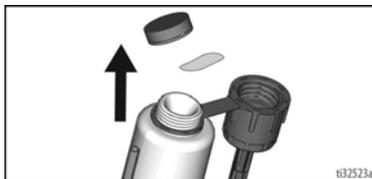
3. En caso de que sea necesario, desenrosque la rejilla de entrada del tubo de aspiración. Mueva la válvula de cebado/pulverización a la posición PRIME (Cebado).
