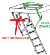
Sichere und einwandfreie Schließung, das einmalige System der Federbefestigung im Lukenkasten und nicht am Deckel schützt vor heftigem Fallen des Deckels.
