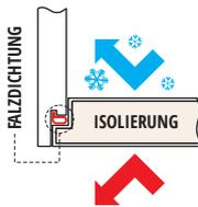
Besonderes System des doppelten Satzes in Verbindung zwischen Lukendeckel und Rahmen. Schützt vor Kälte und Staub.
