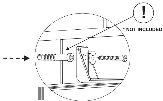
Utilizzare le viti "Vs" e le rondelle "Rs" in dotazione per fissare la squadretta "Sts" al tettuccio dell'armadio (fig I). Successivamente fissare la squadretta "Sts" alla parete (fig II). Per il fissaggio al muro utilizzare viti\* e tasselli\* adeguati alla tipologia di parete a disposizione \* NOT INCLUDED
