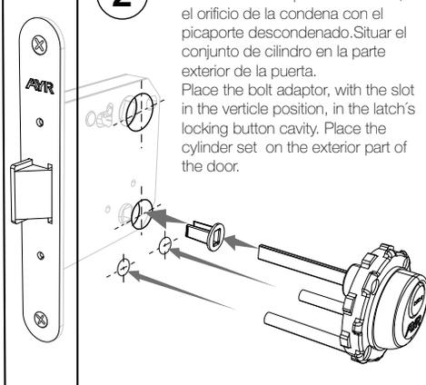
Colocar el adaptador de cuadradillo, con la ranura en posición vertical, en el orificio de la condensa con el picaporte descondenado. Situar el conjunto de cilindro en la parte exterior de la puerta.
