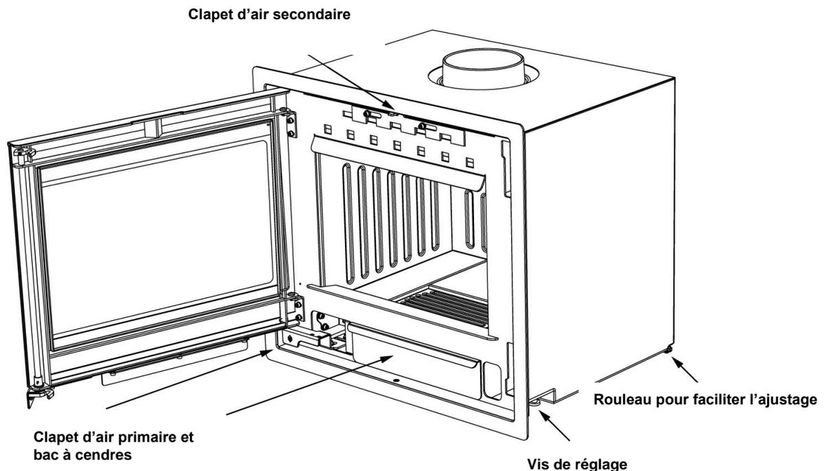
\* Ne pas oublier de fixer les vis de réglage avant que l'insert soit mis en place. Vous trouverez les vis dans le bac à cendre.
