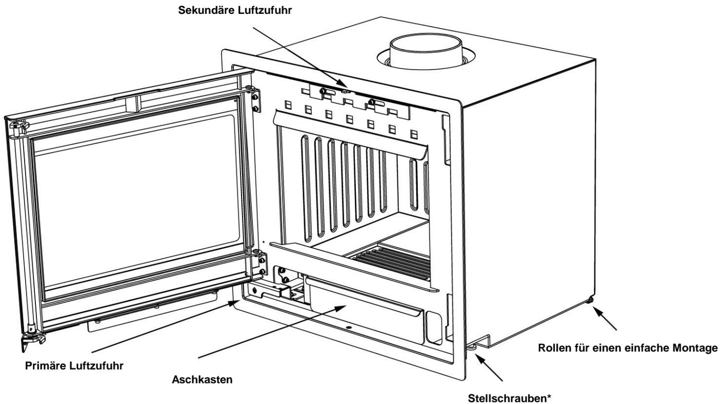
**\* Vergessen Sie nicht die Stellschrauben zu montieren, bevor Sie den Kamineinsatz am gewünschten Ort platzieren. Die Stellschrauben liegen im Aschkasten.**
