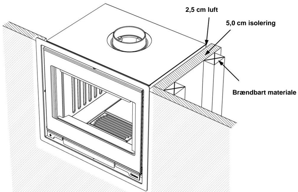
**Bemærk:** at pejseindsatsen skal installeres på et gulv med tilstrækkelig bæreevne. Hvis den eksisterende konstruktion ikke opfylder denne forudsætning, skal der foretages passende foranstaltninger (fx belastningsfordelende plade) for at opnå dette.
