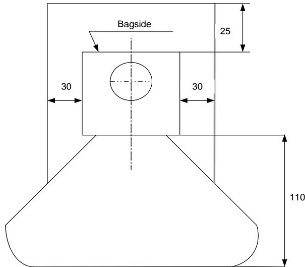
Pour réduire la distance aux matériaux inflammables, vous pouvez isoler Aduro 5-1 avec une isolation de la même qualité que les produits « Aduro Superisol », Isolrath 1000 ou similaire. L'isolation utilisée doit être de 5,0 cm au minimum. Veillez à garder toujours 2,5 cm d'espace libre autour de l'insert. Si vous choisissez d'isoler comme proposé, la distance aux matériaux inflammables peut être réduite à 7,5 cm ( 2,5 cm d'espace libre autour de l'insert + 5 cm de matière isolante).
