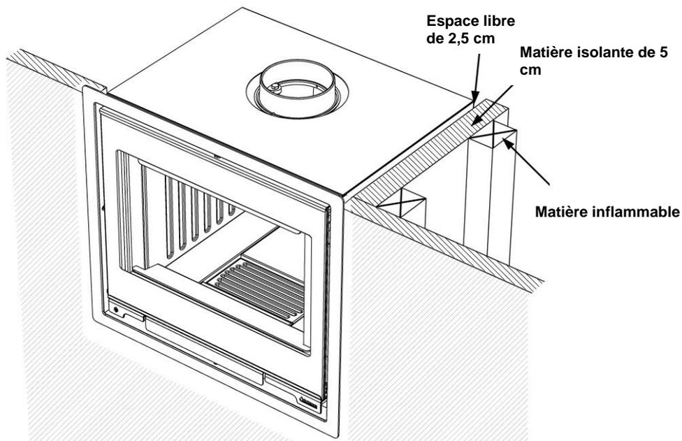
**Remarque:** l'insert à bois doit être installé sur un sol ayant une force portante adéquate. Si la construction existante ne remplit pas cette condition, il convient de prendre les mesures appropriées pour corriger la situation (p.ex. en installant une plaque de répartition de la charge).
