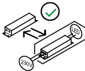
Dieses Produkt enthält einen separaten LED Driver, der durch den Endverbraucher ausgetauscht werden kann.
