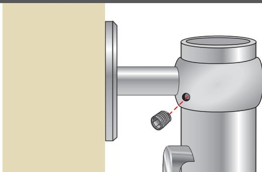
Geländerstab von unten in vormontierten Halter schieben und mit Madenschraube M6x6 befestigen
