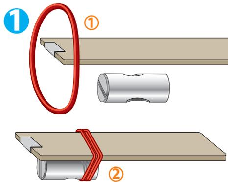
Auf Position des Gummis achten, darf nicht über der Bohrung liegen
