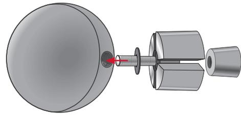
2 x durchführen: Gewindestab M8x35 an Kugel verschrauben. Tellerfeder und Rohrkupplung aufstecken, dann mit Klemmkonus M8 handfest anziehen.
