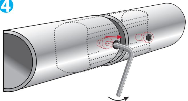
Mit Inbusschlüssel SW5 die beiden Schrauben durch Aufdrehen in der Innenseite des Handlaufs fixieren.
