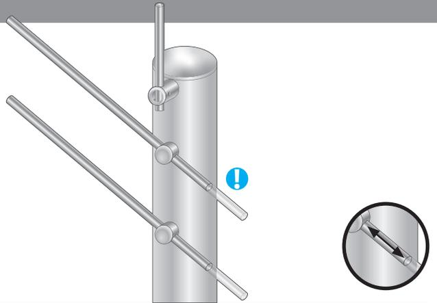
Rundstangen in Klemmhalter stecken und anschliessend fixieren.
