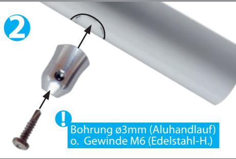
Bohrung  $\varnothing 3\text{mm}$  (Aluhandlauf) o. Gewinde M6 (Edelstahl-H.)
