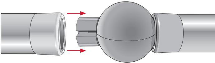
Vormontierte Handlaufenden auf die Kugel stecken.
