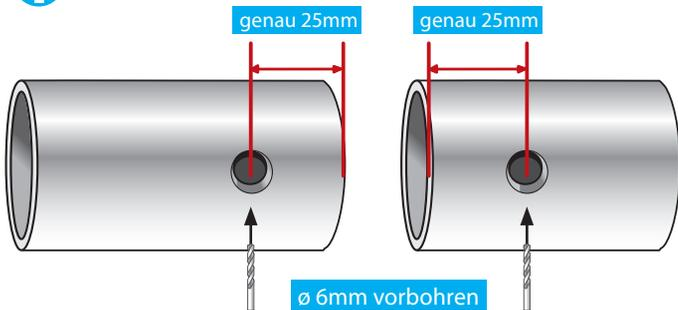
Die beiden Handlaufenden je genau 25mm zu befestigenden Ende vorbohren,  $\varnothing$  6mm.
