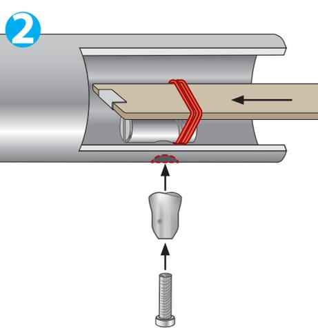
Fixierten Quergewindebolzen M6 mit Zollstock in Handlaufrohr bis zur Bohrung einführen. Von außen Handlaufhalter mit Inbusschraube M6 x 12 in Quergewindebolzen einfügen.
