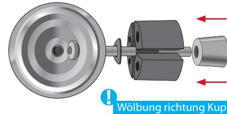
Tellerfeder, Rohrkupplung aufstecken, dann mit Klemmkonus M6 verschrauben.
