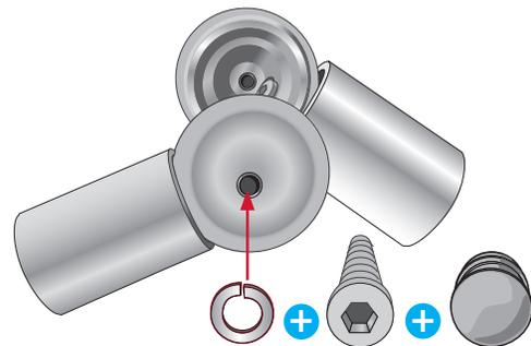
Die beiden Kugelhälften mit Inbus-Schraube M6x40 + Federring  $\varnothing 6$  entsprechendem Eckwinkel fest verschrauben + Kunststoffkappe einschlagen
