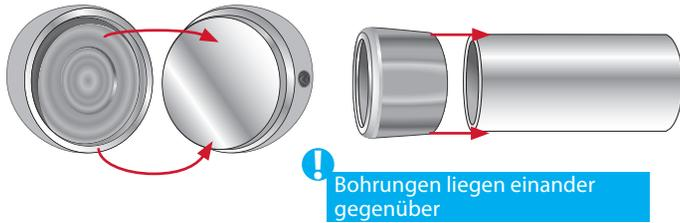
Die beiden Kugelhälften zusammenstecken. Ringadapter auf Handlaufende stecken.
