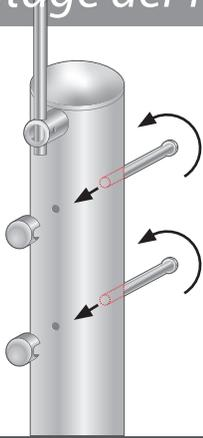
Klemmhalter mit Inbus Schraube M6x50 vormontieren.
