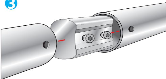
Die beiden vorgebohrten Handlaufenden mit dem Verbinder in der Mitte zusammenstecken.
