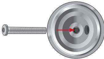
Inbus-Schraube M6 x 50 in seitliche Bohrung der Kugel von innen nach aussen einführen.
