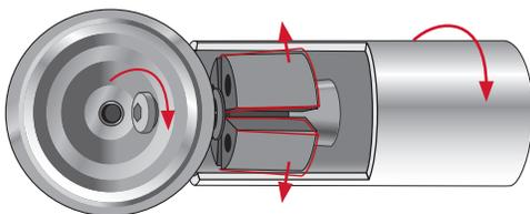
Handlauf fest aufstecken und Schraube mit Inbuschlüssel SW4. Durch Aufspreizen der Rohrkupplung wird die Halterung von innen fixiert. (2 x)
