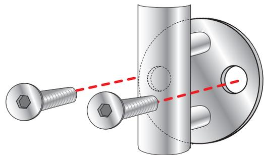
Grundplatte an der Wand mit bauseits zu besorgendem Befestigungsmaterial verschrauben, anschließend Gelenkköpfe wieder montieren und Handlauf befestigen.
