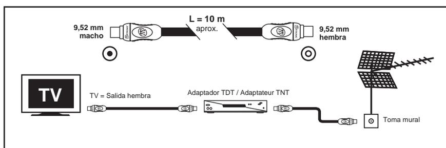
Sirve para conectar aparatos provistos de tomas 9,52mm
