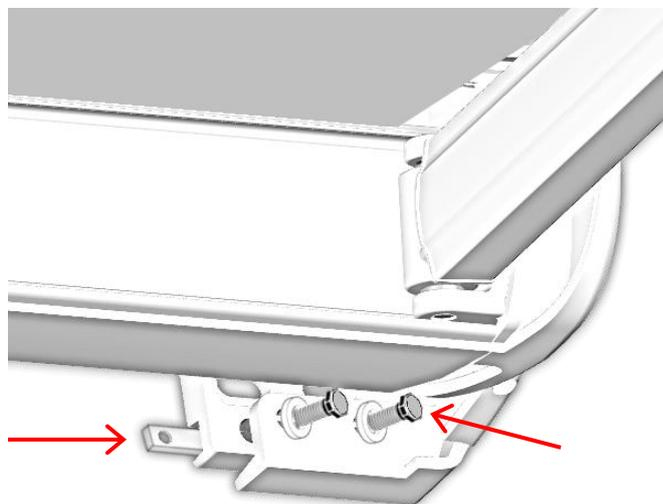
Führen Sie die Gewindeplatte in die dafür vorgesehene Nut ein und drehen Sie die mitgelieferten Sicherungsschrauben mit Unterlegscheibe ein. Ziehen Sie die Schrauben fest, damit sich die Markise nicht mehr aus der Konsole lösen kann.
