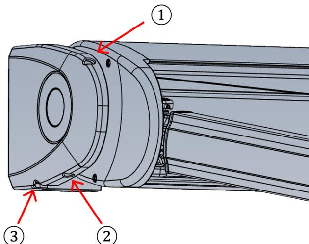
Lösen Sie die Schrauben ① und ② auf beiden Seiten der Markise. Jetzt können Sie mit der Schraube ③ den Neigungswinkel der Markise verstellen. Gehen Sie hier in kleinen Schritten vor, abwechselnd auf der linken und der rechten Seite, so dass der Unterschied zwischen den beiden Seiten nie zu groß wird.
