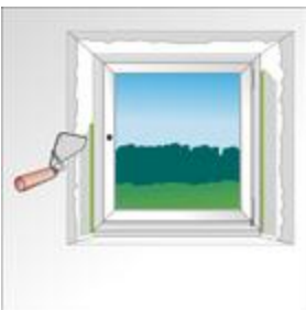
Bild 13: Einputzen und glattstreichen
