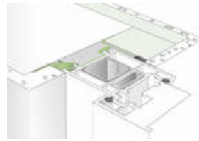
Bild 6: Befestigung der Folie innen wie Außenseite
