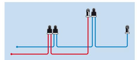
**Strangleitung:** Bei einer Strangleitung werden mehrere Entnahmestellen über einen gemeinsamen Leitungsstrang verbunden. Diese Montageart benötigt relativ wenig Rohrleitungen, aber mehr Formteile als die Einzelanbindung.
