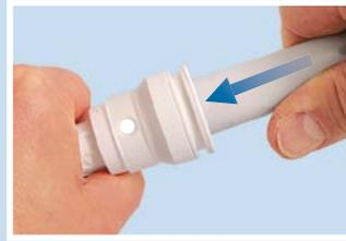
Zur Herstellung einer dichten Verbindung genügt es, das Verbundrohr so weit in den Fitting zu stecken, bis das **Kontrollfenster** weiß wird. Pressgeräte und Schraubenschlüssel sind nicht erforderlich.
