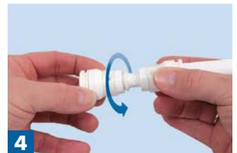
Schrauben Sie die neue Hülse auf den Fittingkörper auf und stecken Sie das kalibrierte Rohr in den Fitting. Fertig!
