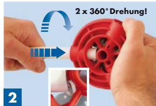
Kalibrieren – Rohr kräftig bis zum Anschlag einstecken und Kalibrierer drehen (2 x 360°). Das Rohrende ist nach der Kalibrierung um 15° angefast (innen und außen).
