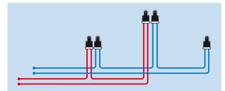
**Ringleitung:** Bei der Ringleitungsanbindung werden mehrere Entnahmestellen über eine Ringleitung von zwei Seiten angeschlossen. Dies ermöglicht eine gleichmäßigere Versorgung aller Entnahmestellen und verhindert eine Stagnation des Wassers.
