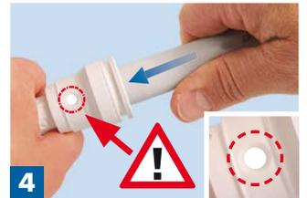
Kontrollieren – wenn das Rohr richtig im Fitting sitzt, wird das Kontrollfenster im Fitting weiß.
