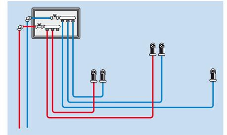
**Einzelanbindung:** Bei der Einzelanbindung werden die Entnahmestellen direkt mit dem Etagenverteiler verbunden. Einfachste Montageart, empfehlenswert bei kurzen Strecken und wenigen Entnahmestellen.
