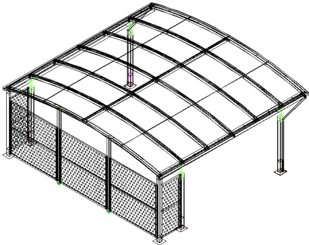
In die Seitenschiene müssen 2 x 4 Löcher gebohrt werden (Teil nr. 3/4 an CALUX Carport), 2 x 2 Löcher in letzte Träger und 2 x 3 Löcher im Beine gebohrt werden. Es wird empfohlen, diese Löcher vor der Montage der Schrauben zu lackieren, damit die Oberfläche in den Löchern geschützt ist.
