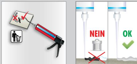
Pressen Sie einen ersten Teil des Produktes aus der Kartusche und prüfen Sie ob die beiden Komponenten Teil A (weiße Farbe) und Teil B (schwarze Farbe) zusammengemischt wurden. Eine ausreichende Mischung ist erfolgt, wenn das Produkt eine gleichmäßige graue Farbe hat. Die Kartusche ist nun fertig für die Anwendung.
