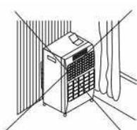
5. NE PAS installer le chauffage proche des murs, des meubles, des rideaux, des draps de lit ou tout autre matériaux inflammables, sous risque d'incendie. Les distances suivantes doivent être respectées. 50 cm sur tous les côtés, et 100 cm sur le devant. TOUJOURS orienter le chauffage vers le centre de la pièce. Le chauffage doit être installé sur une surface à niveau.
