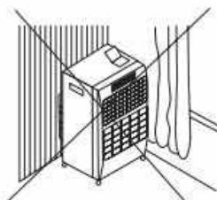
5. NO coloque el calefactor cerca de paredes, muebles, cortinas, sábanas ni materiales inflamables, podría causar un riesgo de incendio. Deben respetarse las siguientes distancias mínimas: 50 cm de los laterales y 100 cm de la parte delantera. Oriente SIEMPRE el calefactor hacia el centro de la sala. El calefactor siempre debe colocarse en una superficie plana.
