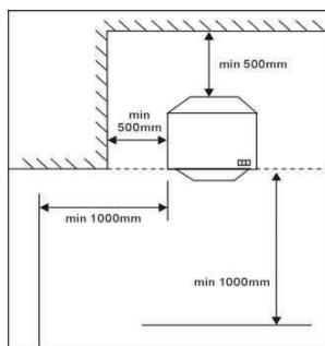
Note : Distance minimum entre le chauffage mobile et le plafond d'au moins 1000 mm.
