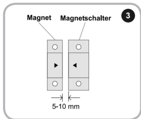
Der Abstand zwischen Magnetschalter und Magnet sollte zwischen 5 -10 mm liegen (Abbildung 3)
