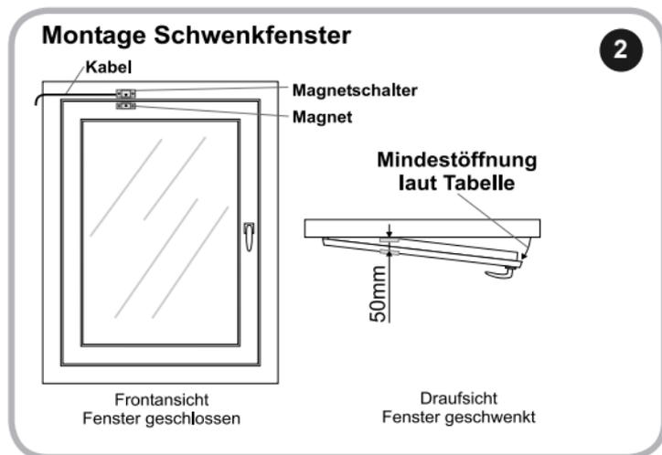
Das Magnetschalter-Gehäuse wird am Fensterrahmen befestigt, der Magnet am Fensterflügel. Der Gesetzgeber verlangt eine mechanische Befestigung beider Teile (4 Stück Schrauben 2,2x6,5 mm sind beigelegt). Die bereits angebrachten doppelseitigen Klebebänder dienen nur als Montagehilfe um die Position des Magneten und des Magnetschaltergehäuses vor dem Festschrauben zu fixieren.
