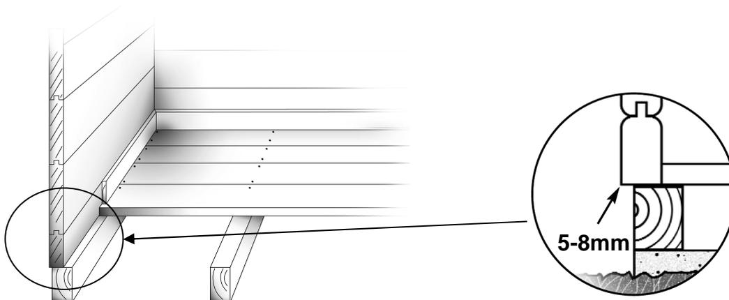
Ahora construya según el esquema 1 la pared hasta el tablón de la pared 3. o. 4 lateral. Anteriormente desplace la puerta completa montada con marcos con cuidado dentro de la sección de la pared.
