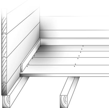
Las láminas del suelo no se instalarán demasiado justas entre sí. Por último las láminas del suelo se clavarán o se atornillarán bien. Acomode los zócalos a las paredes y gírelos.
