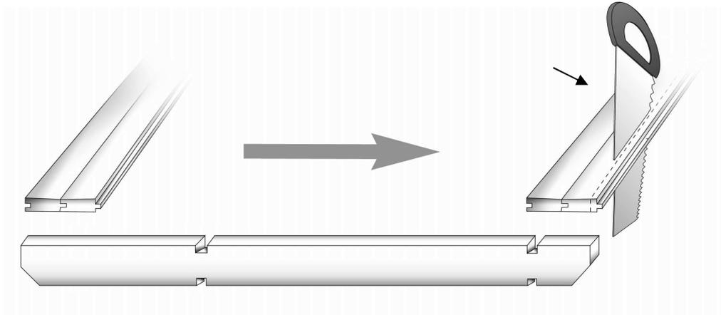
Compruebe otra vez la perpendicularidad de la construcción entera, a continuación comience con el cubrimiento del techo. Empiece con 2 tableros de perfil, con la tuerca hacia afuera, en el canto exterior. Los siguientes tableros de perfil, instálelas planas (no muy justas).
