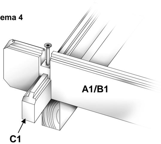
La pared delantera y trasera así como las paredes laterales deben sobresalir aprox. 5- 8 mm de la madera de base.
