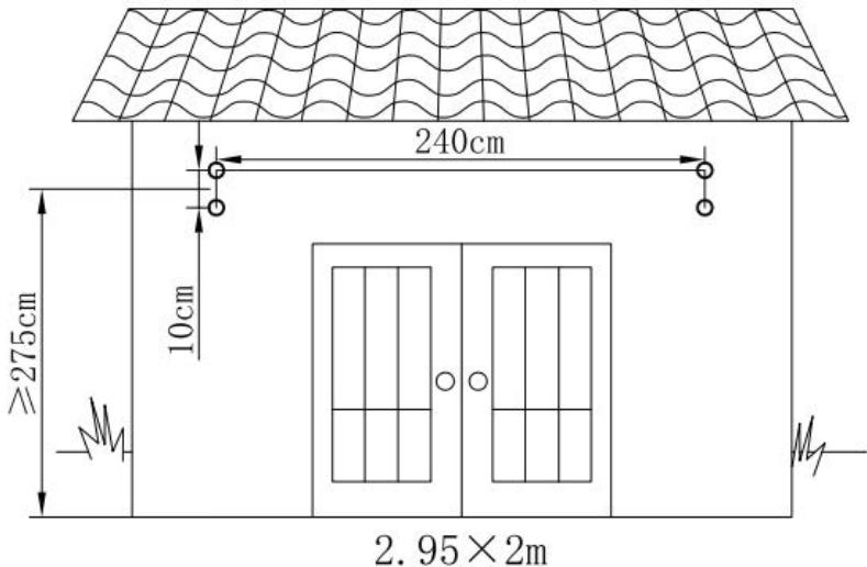
**TIPO DE MURO RECOMENDADO:** reforzado. Paredes de cemento, ladrillo o madera.
