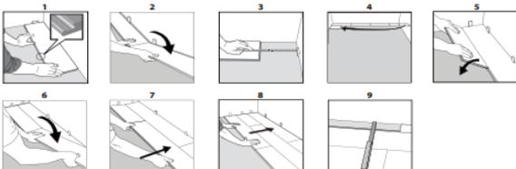
1. Instale el producto de izquierda a derecha, de un lado al otro de la habitación. Coloque la lama con la ranura de encaje mirando hacia dentro de la habitación. Durante la instalación, deberá mantener una separación de 5 mm entre las lamas y la pared o los paramentos verticales. Esto permite que las lamas se expandan y se contraigan de un modo natural.
