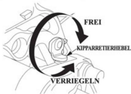
Verwenden Sie den Neigungssperrehebel zum Anheben von dem Außenbordmotor und lassen sie es in der Position einrasten, wenn das Boot vertäut oder verankert ist für eine lange Zeit.
