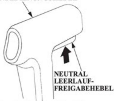
Der Fernbedienungshebel dient zum Einstellen der Fahrtrichtung auf Vorwärts, Rückwärts oder der Neutralstellung, sowie der Veränderung der Motordrehzahl. Den Neutral-Freigabehebel vor Betätigen des Fernbetätigungshebels nach oben drücken.
