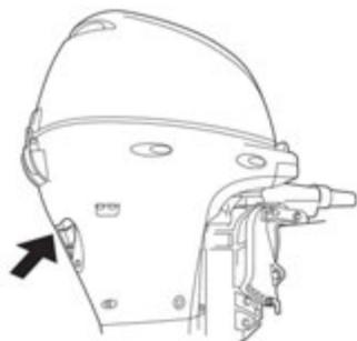
Zum Tragen des Außenbordmotors werden mindestens zwei Personen benötigt. Den Außenbordmotor zum Tragen Bügel halten oder wie hier gezeigt an dem Tragebügel und dem Eingriff unter der Motorhaubenverriegelung halten. Zum Tragen nicht an der Motorabdeckung anfassen.
