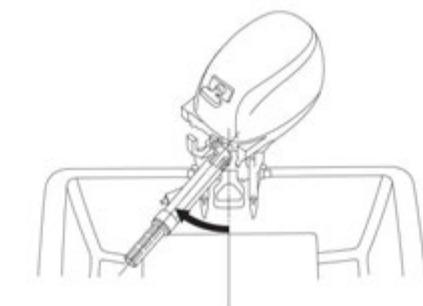
4. Den Kraftstoff vom Kraftstoffdurchgang des Startanreicherungssystems ablassen.
