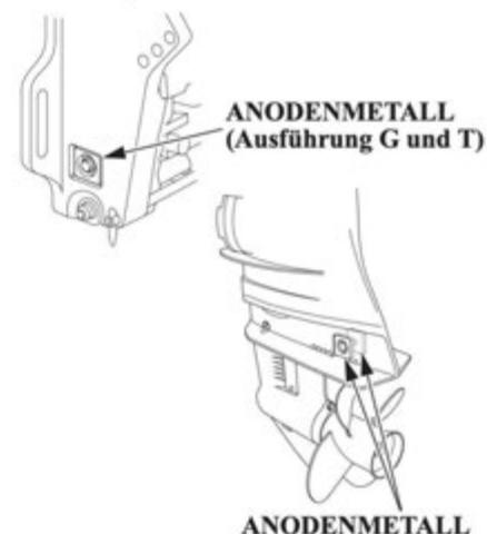
Die Metall-Opferanode schützt den Außenbordmotor gegen Korrosion.
