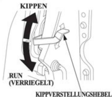
Den Kipphebel zum vorübergehenden Anheben des Außenbordmotors bei Fahren, Vertäuen oder Anker in seichtem Wasser benutzen.
