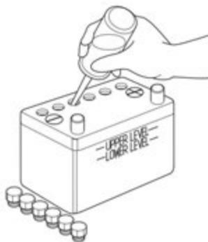
3. Die Batterie mit destilliertem Wasser bis zur oberen Markierung auffüllen. Darauf achten, dass die Batterie nicht überfüllt wird.
