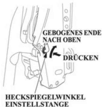
Die Einstellstange hineindrücken, nach oben in die entriegelte Position drehen und herausziehen.
