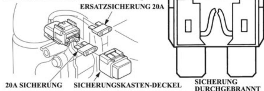
Wenn die Sicherung durchbrennt, wird auch bei laufendem Motor die Batterie nicht mehr geladen. Bevor die Sicherung ausgewechselt wird, die Stromwerte des elektrischen Zubehörs prüfen und sicherstellen, dass keine ungewöhnlichen Zustände bestehen.
