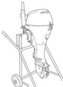
Den Außenbordmotor entweder vertikal oder horizontal wie hier gezeigt transportieren und lagern. Der Außenbordmotor ist an einer Stelle aufzubewahren, die gut belüftet und vor direkter Sonneneinstrahlung sowie Feuchtigkeit geschützt ist.
