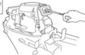
4. Motoröl wechseln (siehe Seite 114). Wenn Wasser in das Motor-Kurbelgehäuse eingedrungen ist, oder wenn das Motoröl Anzeichen von Wasserbeimischung zeigt, muss ein zweiter Motorölwechsel vorgenommen werden, nachdem der Motor 1/2 Stunde lang gelaufen ist.
