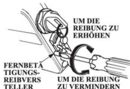
Sich vergewissern, dass sich der Fernbedienungshebel einwandfrei bewegen lässt. Der Reibungswiderstand des Hebels kann durch Drehen des Fernbetätigungs-Reibverstellers nach rechts oder links eingestellt werden.
