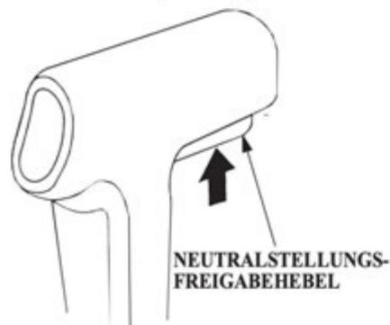
Der Leerlauf-Freigabehebel am Fernsteuerhebel dient zur Verhinderung einer versehentlichen Betätigung des Fernsteuerhebels. Der Fernbedienungshebel ist nur bei gezogener Neutralentriegelung bedienbar.
