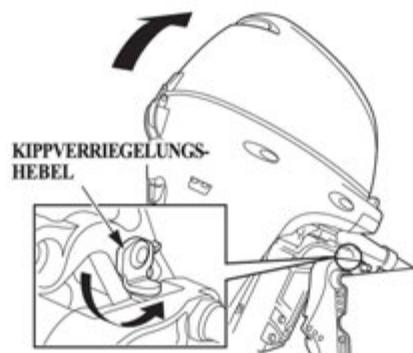
Hochkippen mit dem Kippverstellungs-Sperrhebel. Diesen Mechanismus beim Anlegen des Boots verwenden.
