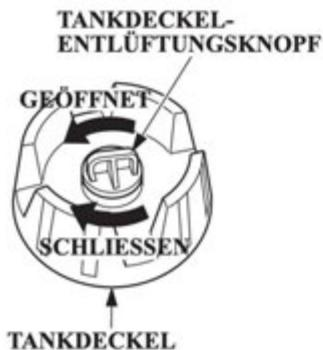
Der Entlüftungsknopf verhindert das Eindringen von Außenluft in den Kraftstofftank.
