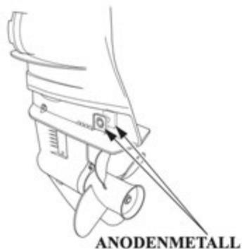
Die Anoden sind als Opferanoden ausgelegt, die dazu beitragen, den Motor vor Korrosionseinwirkungen zu schützen.
