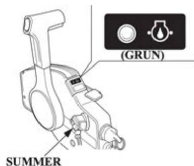
Die Öldruckanzeigelampe erlischt und der Warnsummer ertönt, wenn der Ölstand niedrig und/oder das Motorschmiersystem defekt ist.
