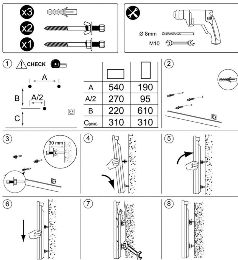
Provjerite mjere i niveliranost prije bušenja. Mjere u mm.
