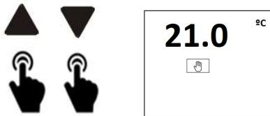
Nakon što ste odabrali ručni način rada, pritisnite tipku ECO za smanjenje sobne temperature od 3°C.
