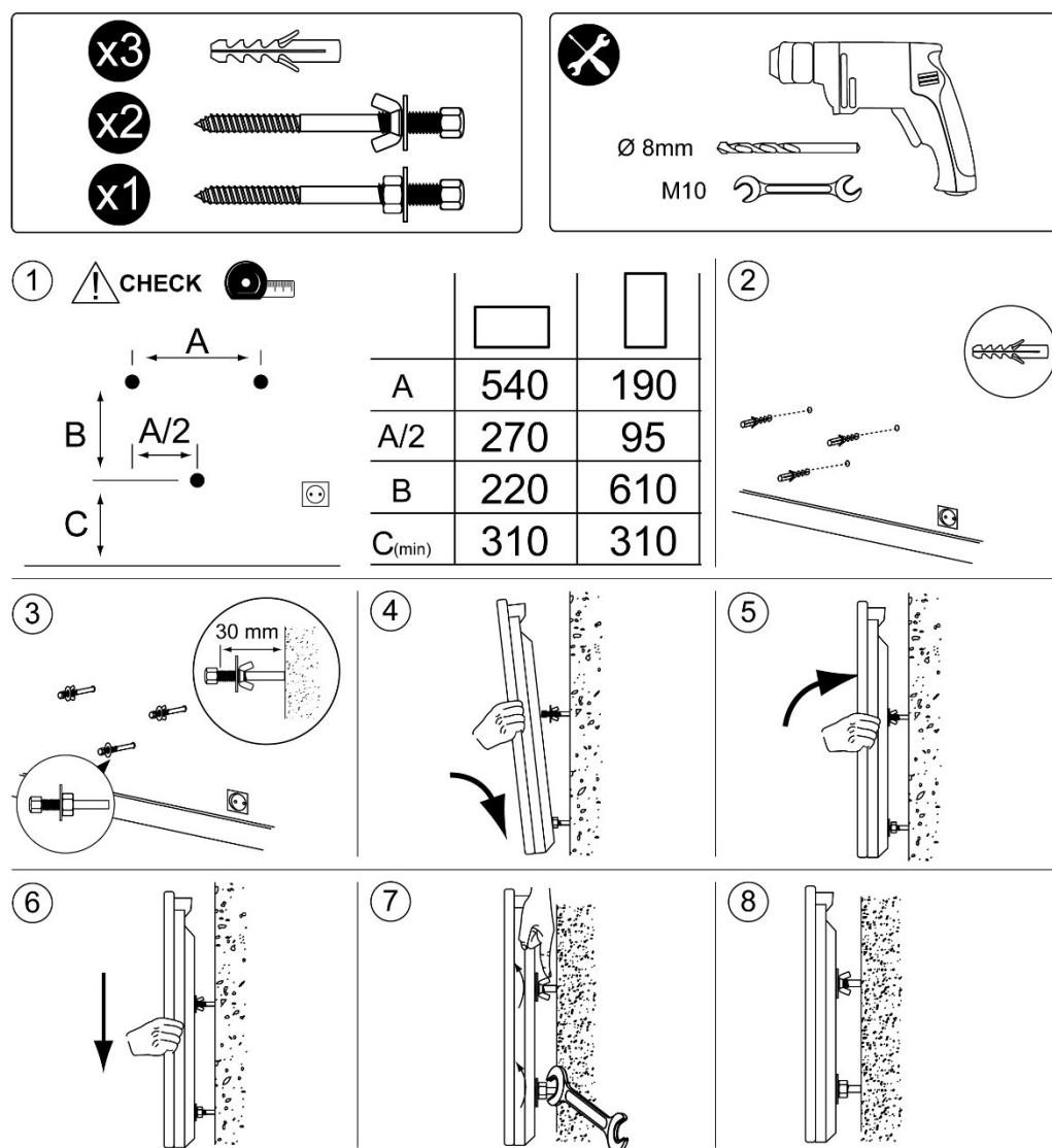
**⚠** Überprüfen Sie die Maßnahmen und Nivellierung vor dem Bohren. Maße in mm.
