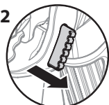
Trekker ontgrendeld (spuiten metpistool mogelijk)
