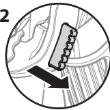
2 Abzug entriegelt (Spritzpistole sprüht)
