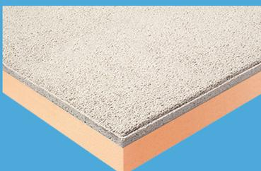
**La baldosa aislante se coloca directamente encima de la capa separadora (geotextil) que protege la impermeabilización, se coloca suelta y preferiblemente a rompe juntas, como aislamiento térmico y acabado de la cubierta.**
