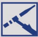
Wolframelektroden werden beim WIG-Schweißen verwendet. Die hohe Schmelztemperatur der Wolframelektroden (ca. 3400°C) begünstigt die Aufrechterhaltung des Lichtbogens zwischen Elektrode und Werkstück, ohne dass die Elektrode zu schnell verbraucht wird. Die Wahl des Elektrodentyps ist abhängig von der Schweißaufgabe. Die Normen EN26848 und ISO 6848 enthalten mehr Informationen zu den Elektroden.
