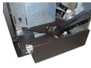
Fig. 73 - Reinigung Rauchgaskammer
