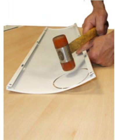
**Fig. 29 - Öffnen Sie das Loch (Modell Sfera<sup>3</sup> Plus)**
