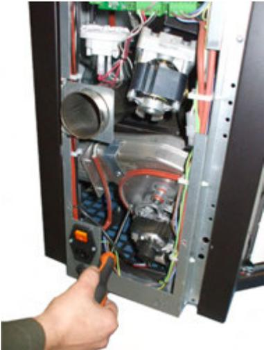
Fig. 76 - Reinigung Rauchgasansauggerät: Phase 1
