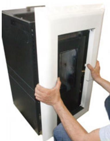
Fig. 36 - Positionierung Rahmen
