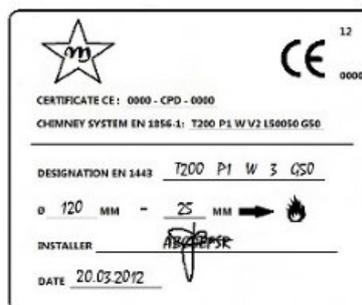
Fig. 3 - Beispiel für Typenschild
