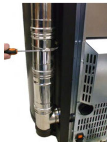
Fig. 75 - Rauchgaskanals (Sfera³ Plus, Sfera³, Globe, Elise³ Plus)
