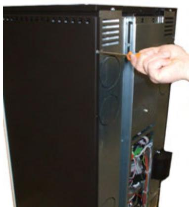
Fig. 57 - Lösen der hinteren Schraube
