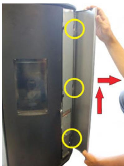
Fig. 61 - Sfera<sup>3</sup> / Sfera<sup>3</sup> Plus: Die Seitenplatten auslösen
