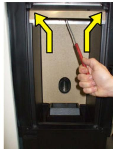
Fig. 70 - Beide Rohre reinigen
