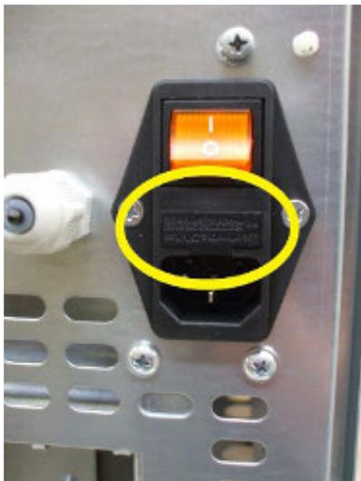
**Fig. 80 - Abdeckklappe mit Sicherungen, die ausgewechselt werden müssen**
