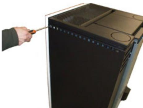
Fig. 56 - Lösen der oberen Schraube
