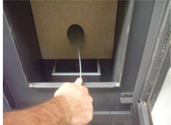
**Fig. 54 - Reinigung mit Flaschenbürste**
