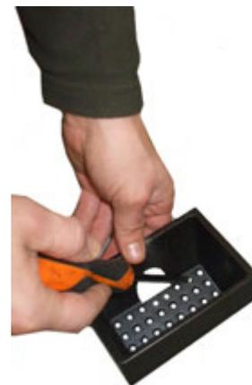
Fig. 52 - Reinigung Brennschale
