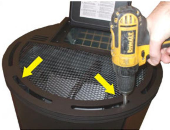
Fig. 62 - Lösen der Schrauben des Deckels 1
