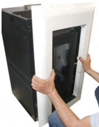
Fig. 22 - Positionierung Rahmen
