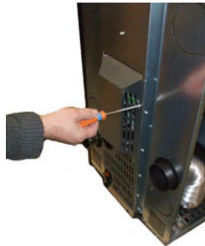
**Fig. 81 - Entfernen hinteres Gehäuse**
