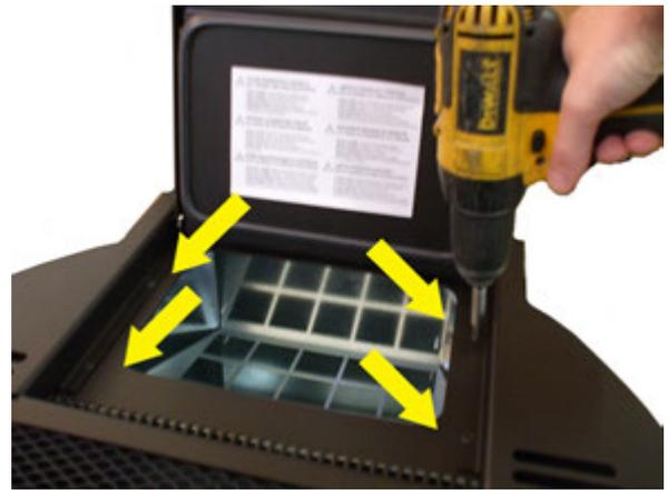
Fig. 63 - Lösen der Schrauben des Deckels 2
