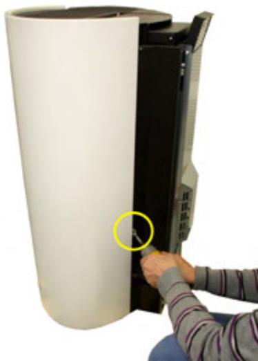
Fig. 66 - Entfernen von Schraube und Bügel
