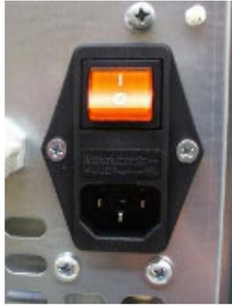
Fig. 38 - Elektrische Steckdose mit Hauptschalter
