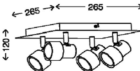
**Descripción:** Spot LED 4 luces metal / blanco incl. 4 x LED/GU10 5W 460lm 3.000K vida útil 25.000h, Ra>=80 no regulable, foco orientable IP20 265x265x120mm (LxAnxA)
