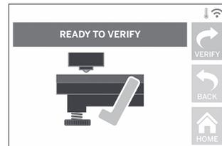
7. Wiederholen Sie die Schritte 4 bis 6 für die zweite Position. Wenn das Druckbett eben ist, bewegt sich der Druckkopf automatisch in die Kalibrierungsposition, und der Ausrichtungsvorgang wird abgeschlossen.
