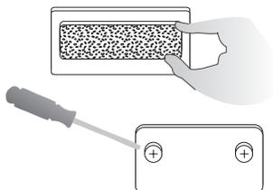
4. Befestigen sie den Montagewinkel mit doppelseitigem Klebeband an der Wand. Halten sie es fuer 10 Sekunden oder benutzen sie 2 kleine Schrauben. BEACHTEN: Das starke Klebeband kann schaden an ihrer Montageoberflaeche verursachen. Testen sie dies bitte vor der Installation.
