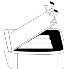
3. Schliessen sie die Batterieabdeckung und drehen die Schrauben fest
