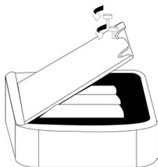
1. Entfernen sie den Montagewinkel von der Rueckseite der Leuchte. Oeffnen sie die Batterieabdeckung indem sie 2 Schrauben entgegen dem Uhrzeigersinn raus drehen.
