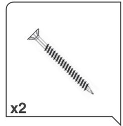
Tornillos tirafondos para madera 5x80 para la unión de la viga con el poste.
