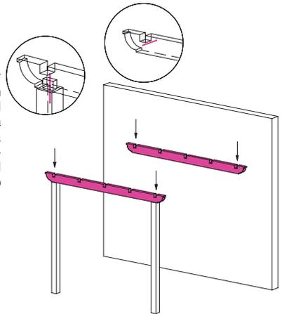
**4 Colocación travesaños.** Tanto las vigas como los travesaños llevan un mecanizado de forma que el último entra dentro del primero. Empezar poniendo los travesaños de los dos extremos y atornillando con un tirafondo de 5x80mm en cada una de las juntas. Repetir la misma operación en los travesaños centrales.
