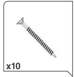
Tornillos tirafondos para madera 5x80 para la unión travesaño - viga.
