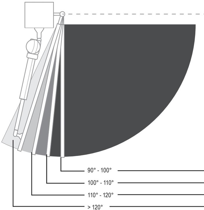
**DE** Um einen störungsfreien Betrieb zu gewährleisten, müssen diese Maße zwingend eingehalten werden. Bitte beachten Sie, dass je nach Öffnungswinkel ausreichend Platz im Fahrbereich des Tores vorhanden sein muss. Sollte sich ein Hindernis im Fahrbereich befinden, muss ein Toranschlag gegeben sein, um den Öffnungswinkel zu reduzieren.
