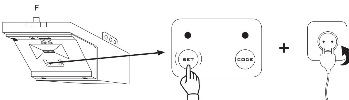
**DE** Drücken Sie die Taste „Set“ und halten Sie die Taste gedrückt. Währenddessen stecken Sie den Stecker des Garagentorantriebs in die Steckdose.
