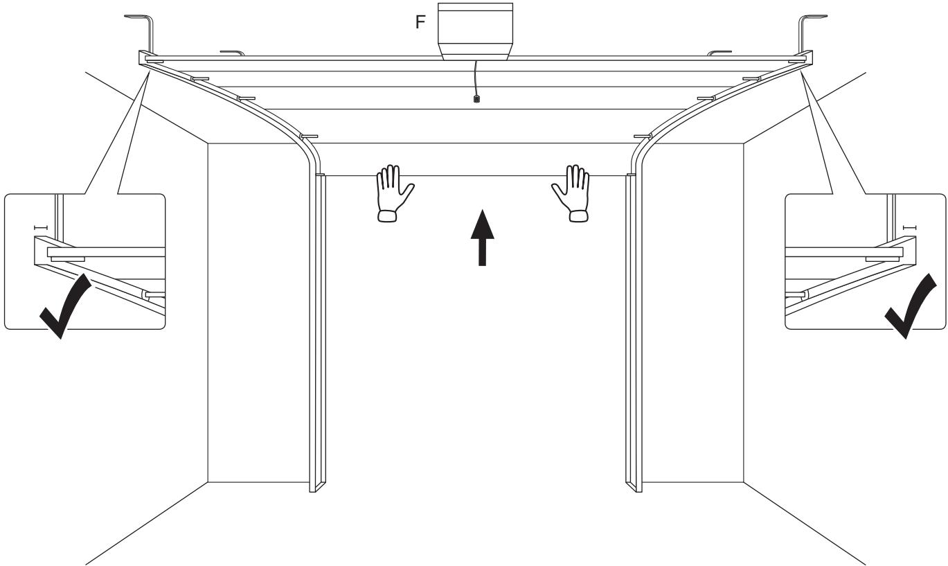
**DE** Schieben Sie das Garagentor in die höchstmögliche Endposition. Vorsicht, wenn der Laufweg der Rollen des Garagentores nicht gesichert ist, kann das Tor herunterfallen!
