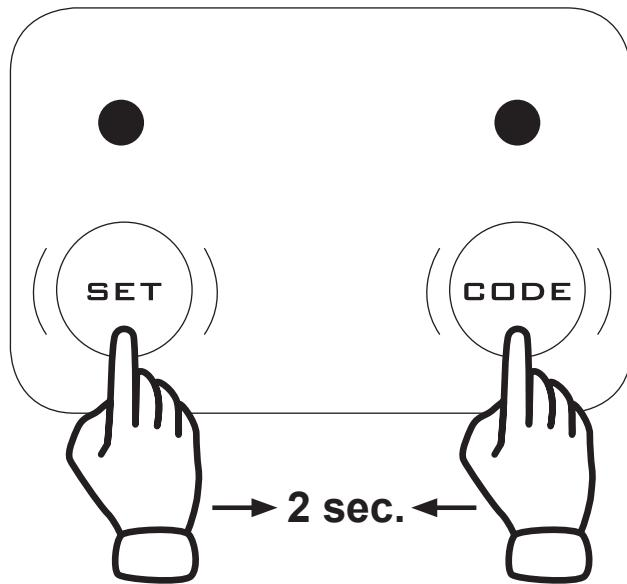
**DE** Betätigen Sie beide Tasten für 2 Sekunden gleichzeitig.
