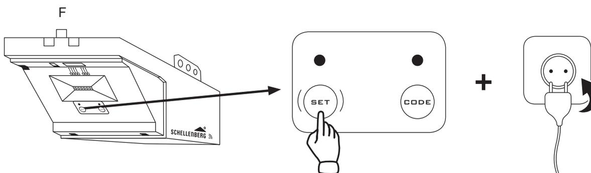
**DE** Drücken Sie die Taste „Set“ und halten Sie die Taste gedrückt. Währenddessen stecken Sie den Stecker des Garagetriebes in die Steckdose.
