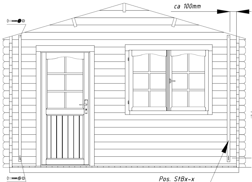
Installatie van de stormankers:
