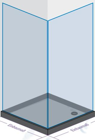
b) bodengleicher Einbau
