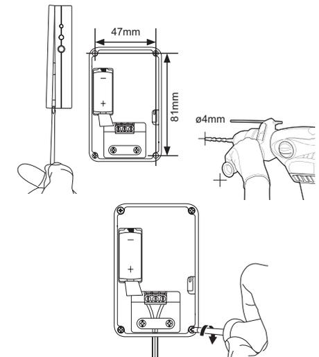
Bringen Sie den Detektor mit doppelseitig klebenden oder mit Hilfe der mitgelieferten Dübel und Schrauben an der Wand. Die mitgelieferte Halterung ist nur für Mauerwerk geeignet.
