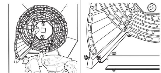
Befestigen Sie die Aufrollvorrichtung im Inneren des Kastens. Wir empfehlen einen Schraubenmutter M4 und 4 Kreuzschrauben M4 (Länge je nach Rollladenkasten) Befestigen Sie die Kordel mit der letzten Latte des Rollladens. Wir empfehlen 1 Schraubenmutter M4 und 1 Flachkopfschraube M4.
