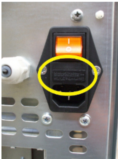
Fig. 80 - Abdeckklappe mit Sicherungen, die ausgewechselt werden müssen
