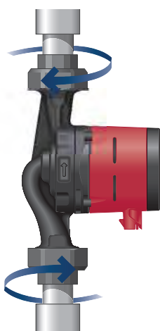
Abb. 3 Einbau der GRUNDFOS ALPHA2
