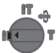
Položaj za bušenje bez čekića u drvo, metal, keramiku i plastiku, kao i za uvijanje vijaka
