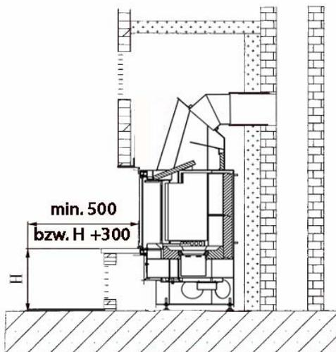
Vor dem Heizeinsatz muß der Fußboden aus brennbaren Materialien durch einen ausreichend dicken Belag aus nicht brennbaren Baustoffen geschützt oder ersetzt werden.
