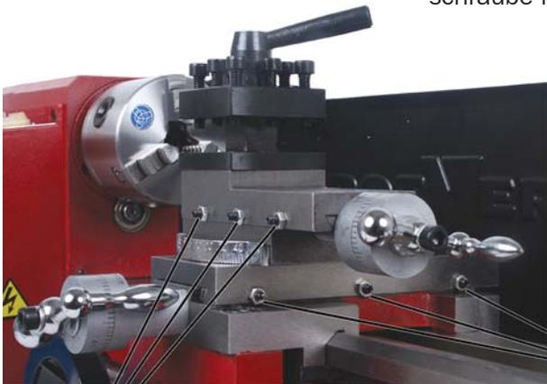
*Justageschrauben und Kontermuttern zum Justieren des Planschlittens*
