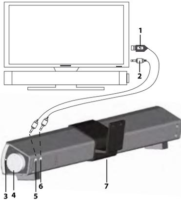
1. Prüfen Sie, ob die Halterung für Ihren Fernseher geeignet ist. Die Befestigung erfolgt mit zwei Schrauben an der Aufnahme des Standfußes.
